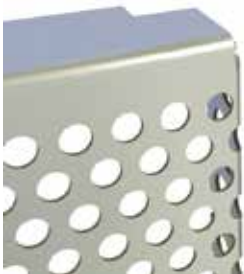
RV 6-8 Lochanteil: min. 44%, max. 48 % abhängig von Paneelbreite Lochdurchmesser: 6 mm
