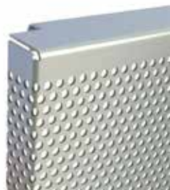
RV 3-5 Lochanteil: min. 29%, max. 31 % abhängig von Paneelbreite Lochdurchmesser: 3 mm
